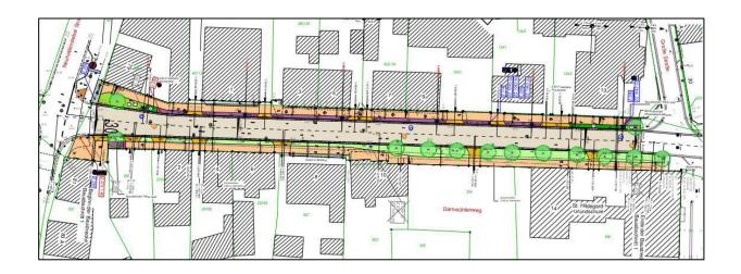
Im Zuge der geplanten Umgestaltung der Straße "Dammühlenweg" (1. TA, ca. 145 m lang) werden der Straßenkörper (B= 6,00 m) und die Gehwege (B= i. M. 2,00 m), die beidseitig der Fahrbahn angeordnet sind, grundhaft ausgebaut. Die Oberfläche der Fahrbahn wird mit Asphalt (2-lagig) und die der Gehwege mit Betonsteinpflaster befestigt.
